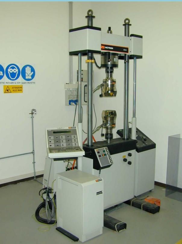
*Tramite l'applicazione del carico la provetta subirà la rottura e permetterà di determinare le caratteristiche nominate nella prova precedente.*
